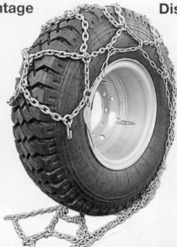
Spannkette aushängen, Spannhebel öffnen, Außenhaken **und** Innenhaken öffnen. Ketten nach außen herunterziehen.
